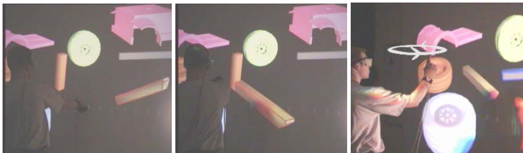
Abbildung 5 Zwei multimodale Interaktionsbeispiele. Linkes und mittleres Bild: „Nimm [Zeigegeste] dieses Rohr und verbinde es mit [Zeigegeste] dem Teil“. Rechtes Beispiel: „Und nun drehe es so [Start Rotationsgeste] herum [Ende Rotationsgeste]“.
