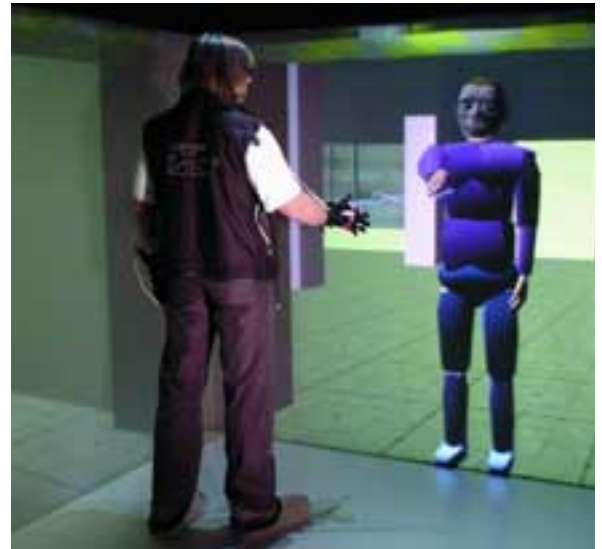
Bild 10: Max hat proximische Sensoren („Körperfühler“), mit denen er Nähe und Annäherung spüren kann. Wenn eine menschliche Hand – mit einem Datenhandschuh bestückt – und Max' computeranimierte Hand sich in der virtuellen Welt treffen, knistert und funkt es.
