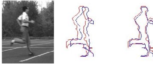
Abbildung 3: Bestimmung der Position mit Hilfe der Silhouette.
