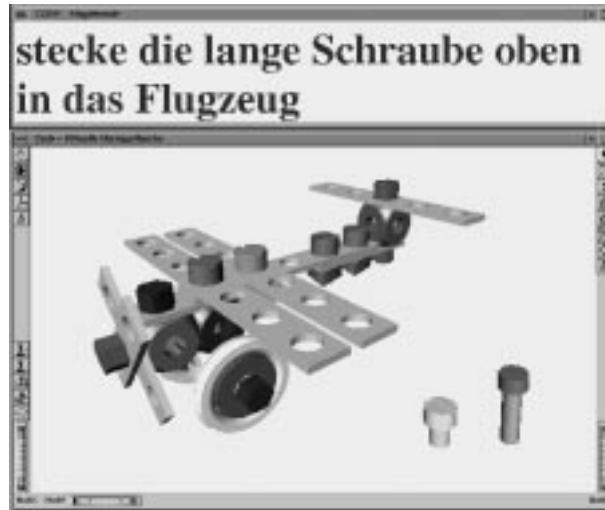
Abbildung 2: In der Desktop-Version des Virtuellen Konstrukteurs können dreidimensional visualisierte Bauteile u.a. mittels sprachlicher Anweisungen zusammengebaut werden.
