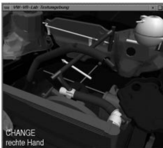
Abbildung 2: Leitungsverlegung in einer virtuellen Umgebung
