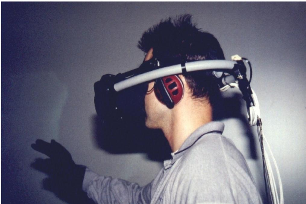
**Abb. 3.** EyePhone und DataGlove der Firma VPL Research, Kalifornien
