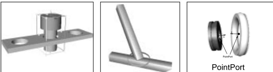
Abbildung 2: Typen von Verbindungsports beim Virtuellen Konstruieren: Extrusion ports (links), plane ports (mitte) und point ports (rechts). Bei Verbindungen zwischen den jeweiligen Ports besteht jeweils ein Freiheitsgrad bzgl. Rotation sowie bis zu zwei Freiheitsgrade bzgl. Translation (Abbildungen nach [7]).
