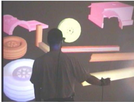
Abbildung 1: Virtuelles Konstruieren an einer interaktiven Wand.
