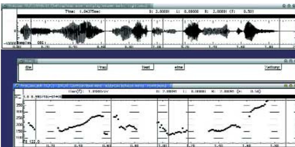
Abbildung 1: Die Äußerung „Die Frau liest eine Zeitung?“ ist in Panel a) als komplexes Sprachsignal im Oszillogramm, in b) mit ihren dazugehörigen Labels (den einzelnen Wörtern) und in c) als Grundfrequenzverlauf zu sehen.
