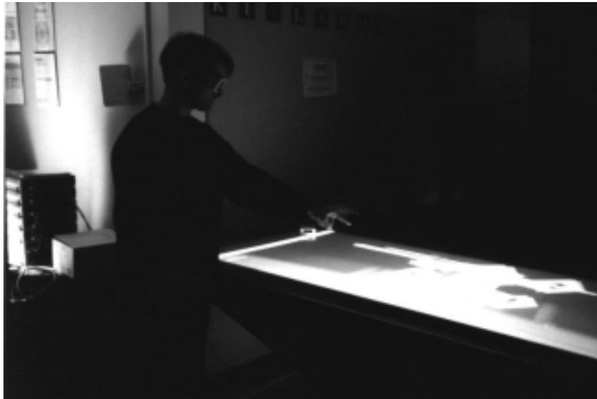
Abbildung 3-3 : Interaktive Montage komplexer Aggregate auf einer virtuellen Werkbank
