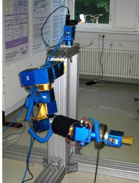
Abbildung 5: Roboterarm mit planaren Sensoren an Schulter, Oberarm, Ellenbogen und Handrücken und einem flexiblen Sensor, der um den Unterarm gewickelt ist
