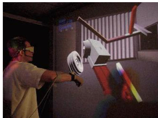
Abb. 1: Montage CAD-basierter Bauteile mit dem Virtuellen Konstrukteur: Links wird die Abgasanlage eines Automobils mittels sprachlicher Instruktionen gefügt (IGES-Datensatz der Volkswagen AG). Rechts werden Rahmenteile eines Kleinfahrzeugs unter sprachlich-gestischen Instruktionen virtuell zusammengesetzt, bei zusätzlicher Auswertung der Blickrichtung.
