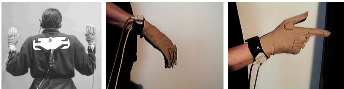
Abb. 2: Gestenerfassung mit Positions-/Bewegungssensoren an Handgelenken, Stereobrille und Rücken (Körperreferenz) sowie Datenhandschuhen, über die Fingerstellung und Handspannung ermittelt werden (Spracheingabe über Kopfmikrofon).
