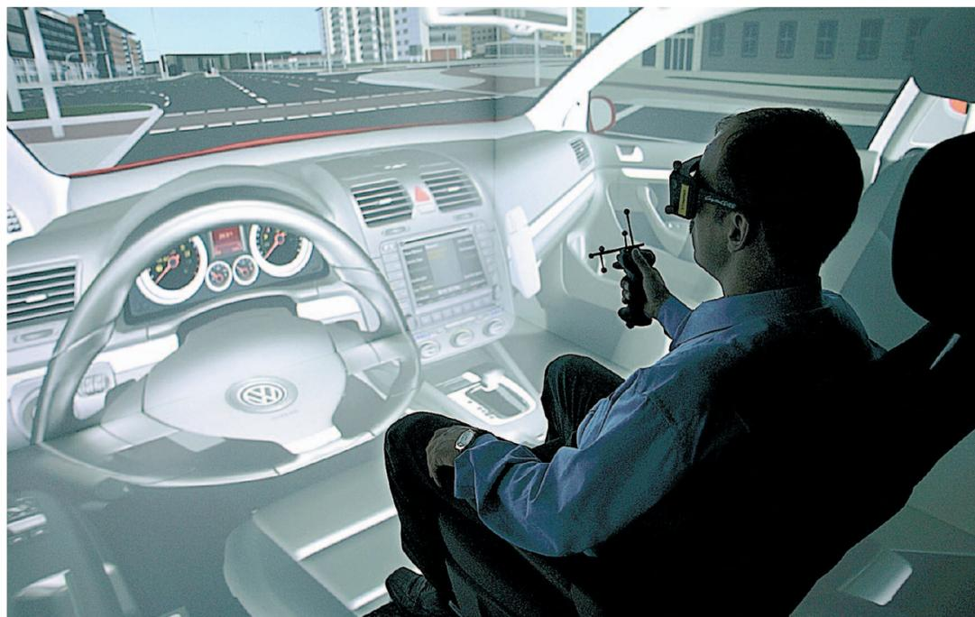
In einer anderen Welt: Der Auto-Tester, der Sitz und der Stick in der Hand zum Bedienen sind echt. Den Rest gibt es nur virtuell. Mit dem Plastikgerät in der Hand kann das Lenkrad angefasst oder der Spiegel verstellt werden.
