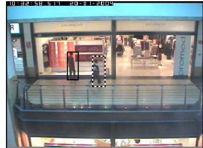
Beispielbild einer Überwachungskamera, Ground Truth und Trackingergebnis eingezeichnet
