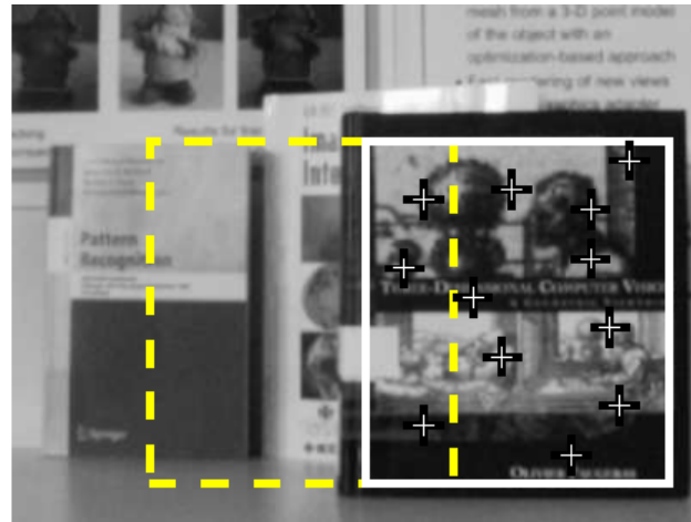
Links: Initialisierung des Trackers. Mitte: Objekt nach Translation. Rechts: nach Translation und Skalierung.
